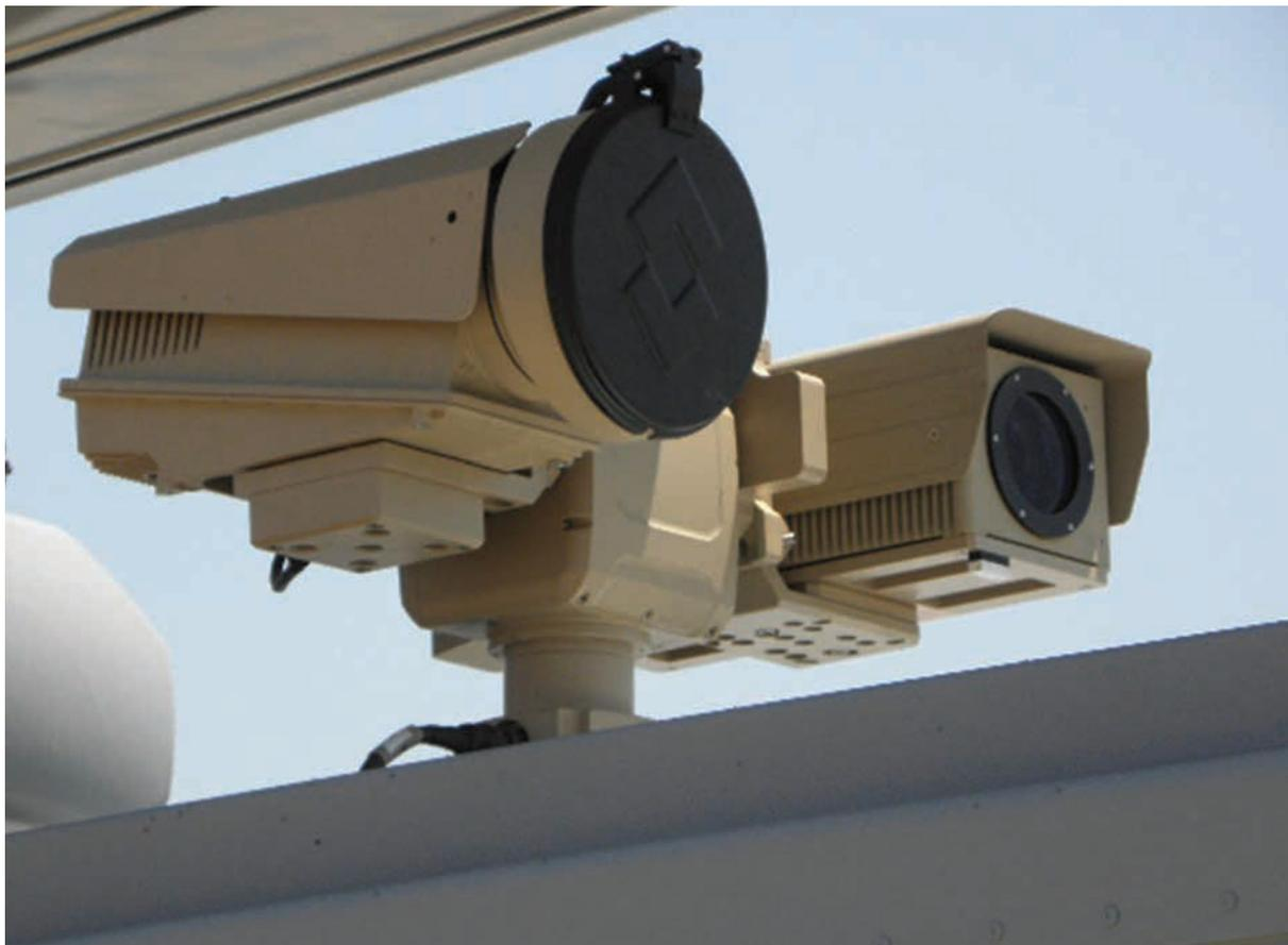
respectivos sensores. Com os radares, será possível detectar os alvos que circulem na zona de operações e, com as câmaras de infra-vermelhos e de luz, será possível a identificação dos alvos detectados. A possibilidade de utilização, em simultâneo, destes dois tipos de sensores permite uma maior eficácia, uma vez que o radar se destaca pela sua capacidade de detecção e seguimento e o sistema electro-óptico pela sua capacidade de identificação e seguimento de alvos.
