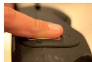
Fig. 9 – Scanner das impressões digitais no HIIDE.
