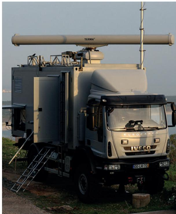
Figura n.º 51 Posto de Observação Móvel, com equipamentos eletro-óticos e militar no exterior do posto a operar com meio de vigilância binocular, com capacidade de infravermelhos (Fotografia da UCC/GNR).
