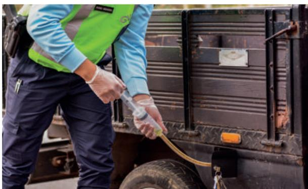
Imagem 28 - Execução de teste ao Gasóleo marcado e colorido
